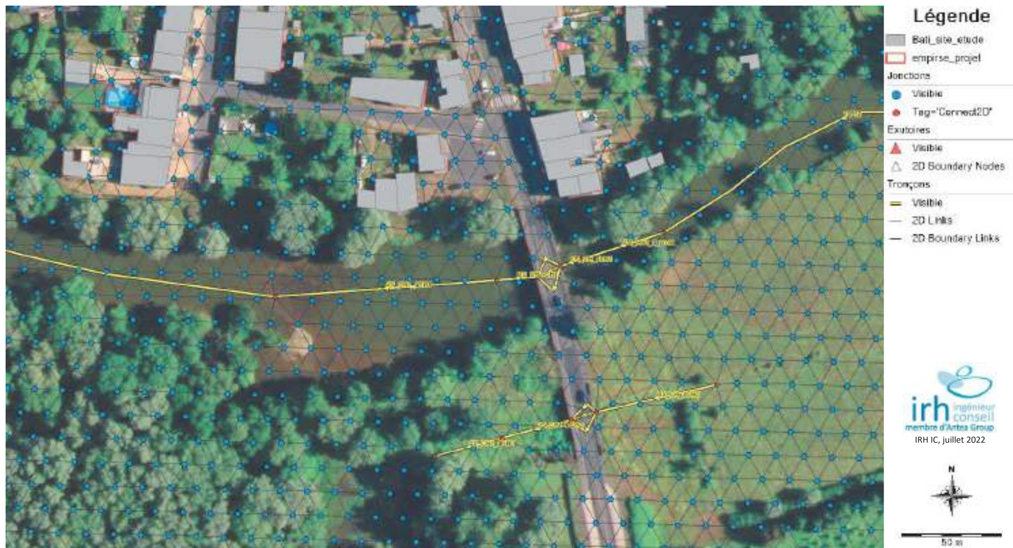
Figure 18 : extrait du modèle 2D - modélisation du lit majeur (IRH IC, juillet 2022)
