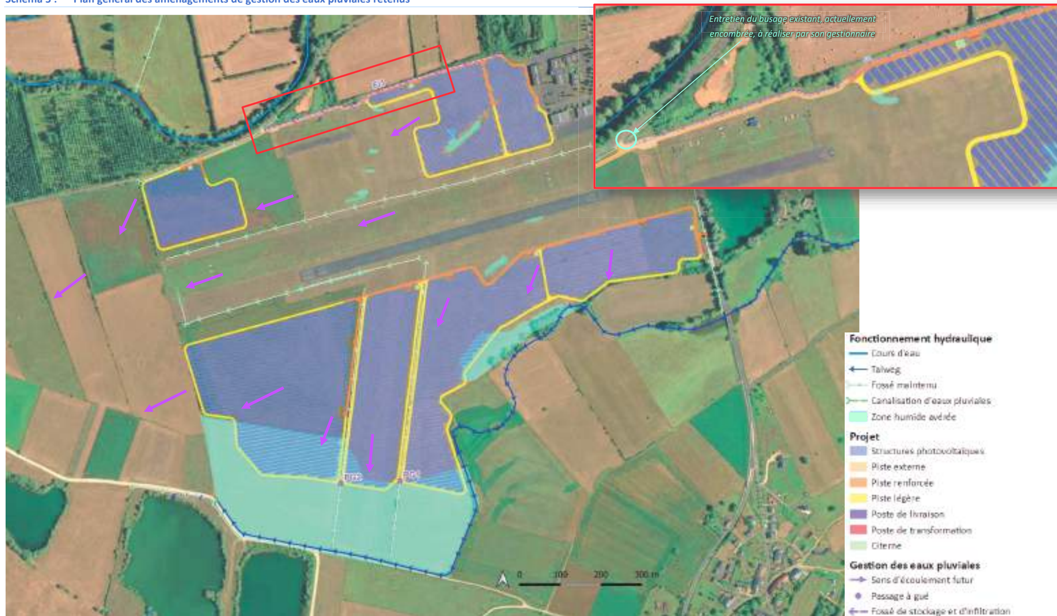
Schéma 5 : Plan général des aménagements de gestion des eaux pluviales retenus
