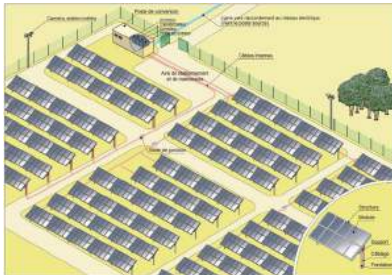
Figure 4 : Schéma de principe d'une centrale-type photovoltaïque
