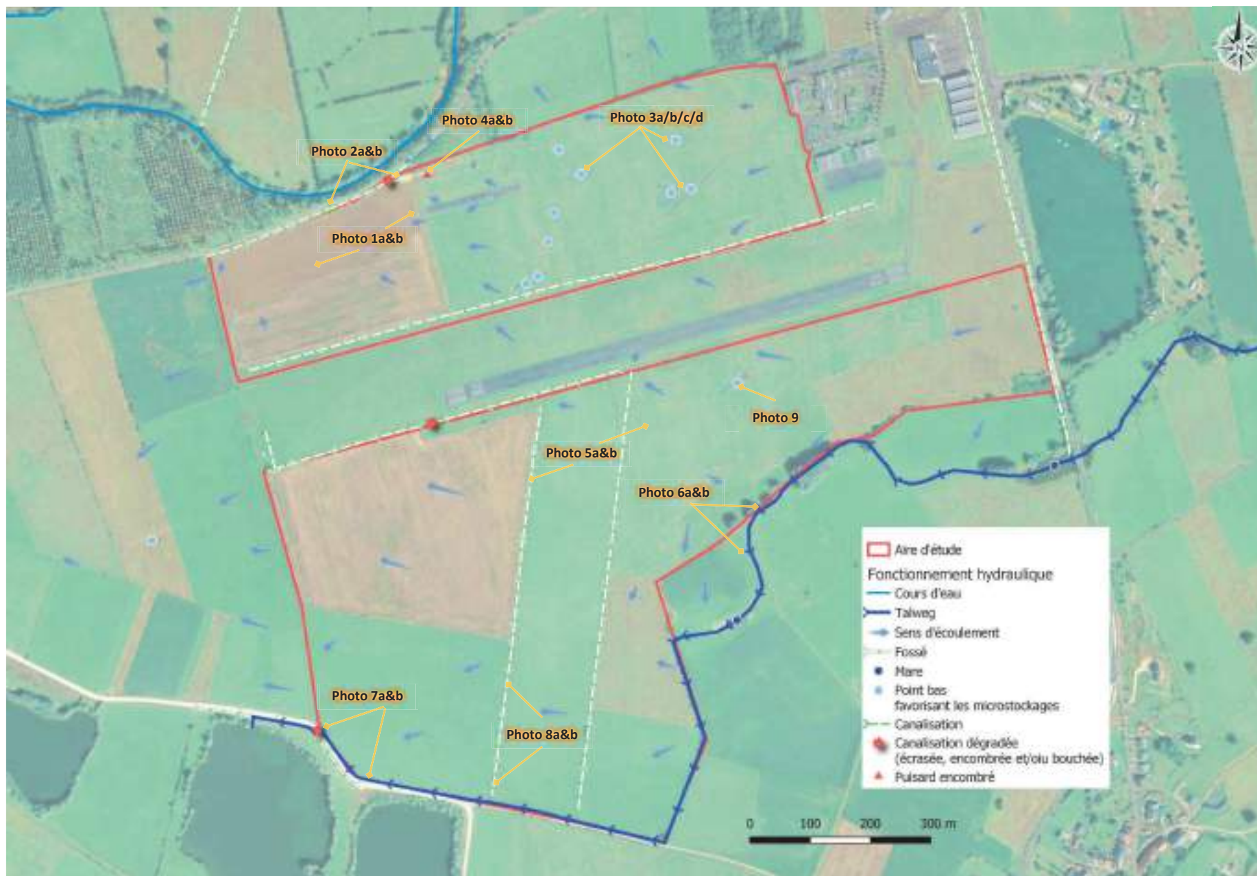
Schéma 14 : Fonctionnement hydraulique au droit de l'aire d'étude
