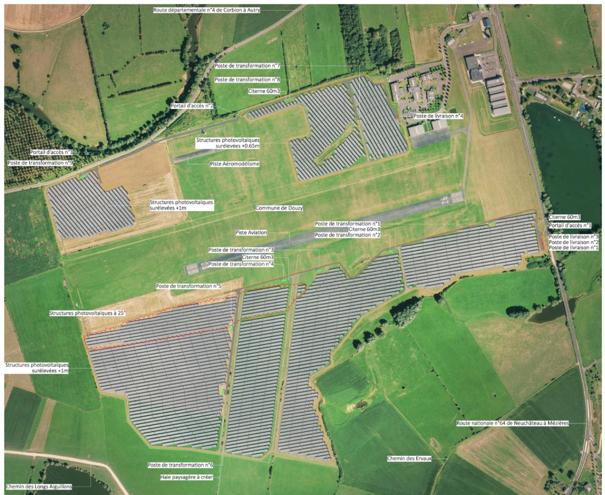
Figure 8 : Plan de masse du projet avec vue aérienne en fond de plan – Sources : EDF Renouvelables
